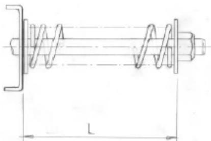
Vérifiez les réglages du système de sécurité mécanique du convoyeur, qui doit être ajusté en fonction de la longueur totale de l'appareil et des tables de sortie.
